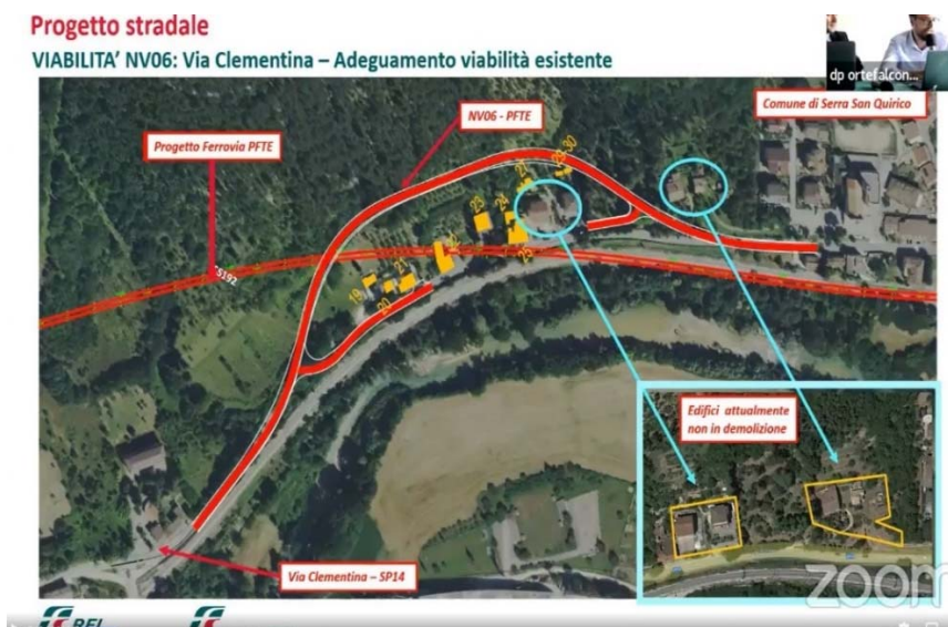
Figura 10 – Planimetria ricucitura strada Provinciale SP14 denominata NV06, contenuta nel progetto fattibilità tecnica economica del Lotto 2 (Genga-Serra San Quirico)
